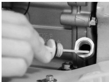
Fig. 5 – Verificarea nivelului de ulei la motor
